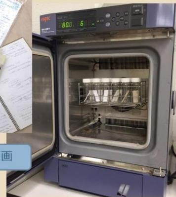
恒温恒湿槽による強制劣化試験
